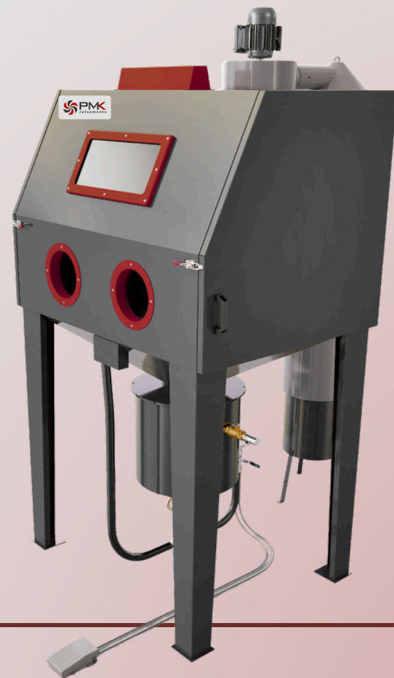
Gabinete de Pressão
